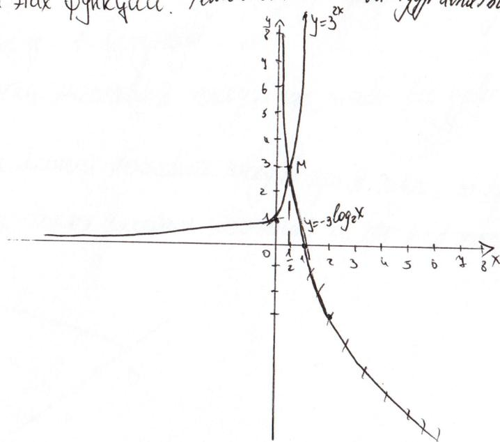
В При  $y \geq 0$  функция  $y = 3^{2x}$  - возрастает, а функция  $y = -3 \log_2 x$  - убывает, значит их графики могут пересекаться только в одной точке.
